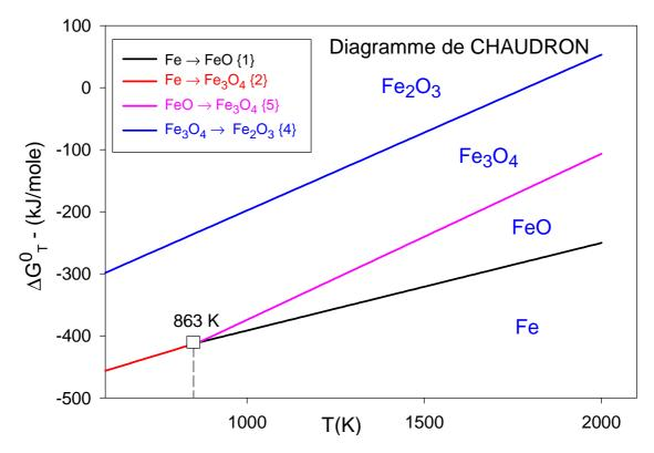
Réduction des oxydes de fer par l'oxyde de carbone : A T>1000 K, le réducteur est CO gaz.
